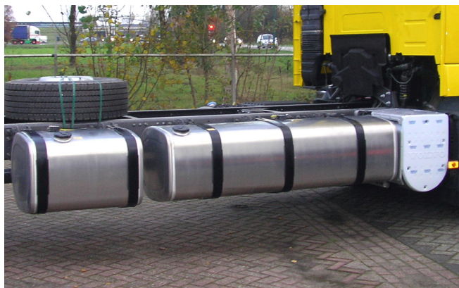
Brændstoftanke i aluminium monteret i højre side (R885A56).
